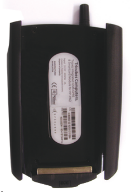
A Tricubes Tripaq: GSM and Smartcard Module for HP iPAQ / Tricubes Tripaq: Modul GSM dan Kad Pintar untuk HP iPAQ
